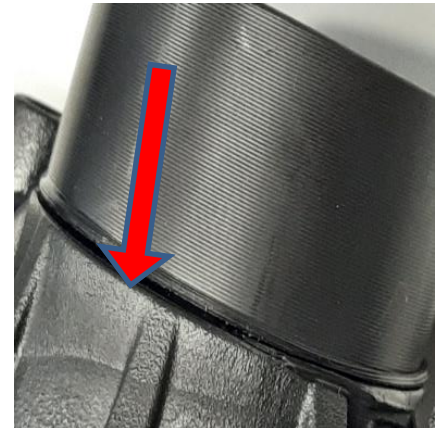
Figuur 1: plek waar de lekkage optreed
